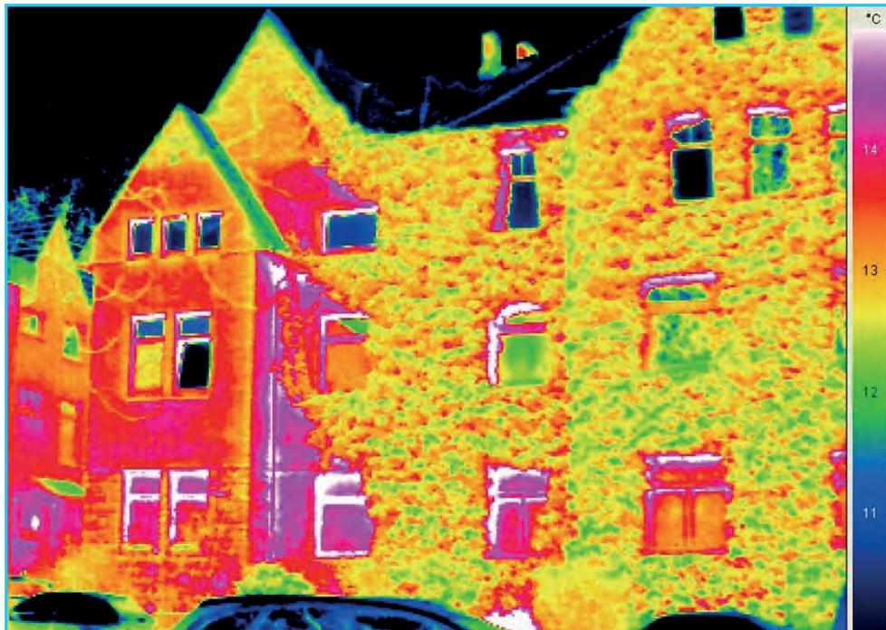
**Abb. 15: Einfluss einer Fassadenbegrünung auf die Oberflächentemperatur eines Gebäudes**
