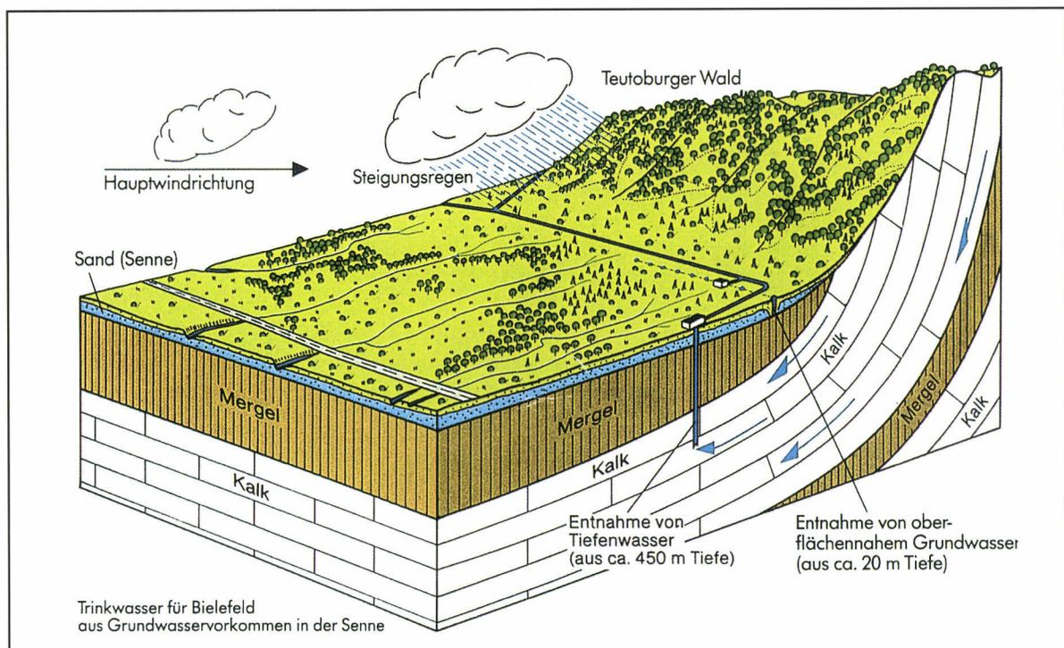
**Abb. 98: Trinkwasserentnahme aus dem Grundwasservorkommen in der Senne**
