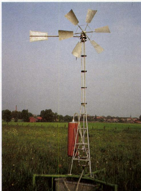
**Bild 3:** Versuchs-Windpumpe im Klimameßfeld der Universität Münster Nabenhöhe ca. 3,6 m
