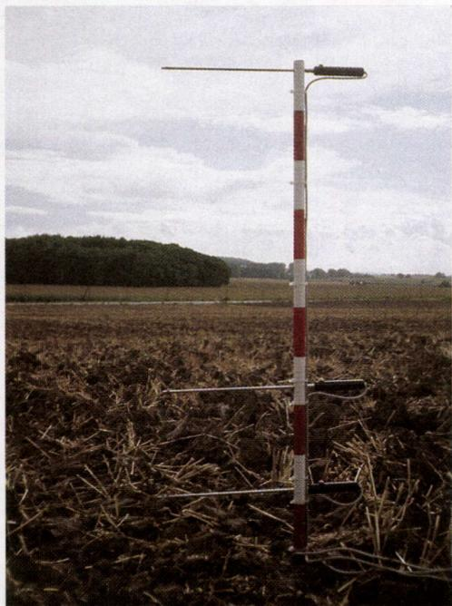
**Bild 1:** Windgradienten-Meßanlage zur Bestimmung der bodennahen Schubspannung. Höhe der thermoelektrischen Anemometer hier ca. 13, 44 und 97 cm
