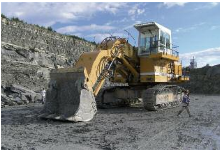
Abb. 1: Mit riesigen, 130 t schweren Hydraulikbaggern, z.T. durch Sprengungen unterstützt, wird der Kalkstein im Steinbruch gewonnen (Foto: Stadt Beckum)
