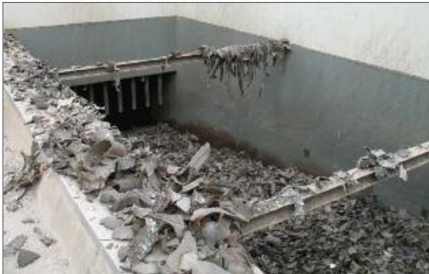
Abb. 9: Anlieferung von zerschnittenen Altreifen als Brennmaterial im Zementwerk Kollenbach (Foto: Geographische Kommission für Westfalen)
