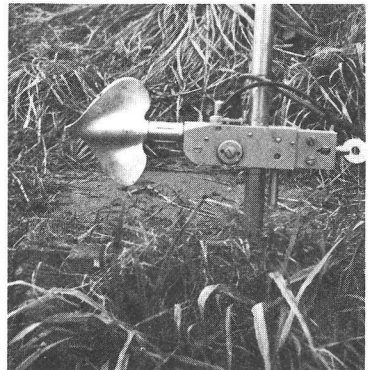
Bild 4: Meßflügel mit 12 cm-Schraubendurch- messer
