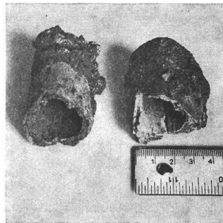
Bild 27 Keramische Winddüsen von Schachtöfen Bezirk Krummenscheid
