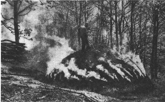
Bild 1 Kohlenmeiler am 8. Brandtag (nach Fickeler)
