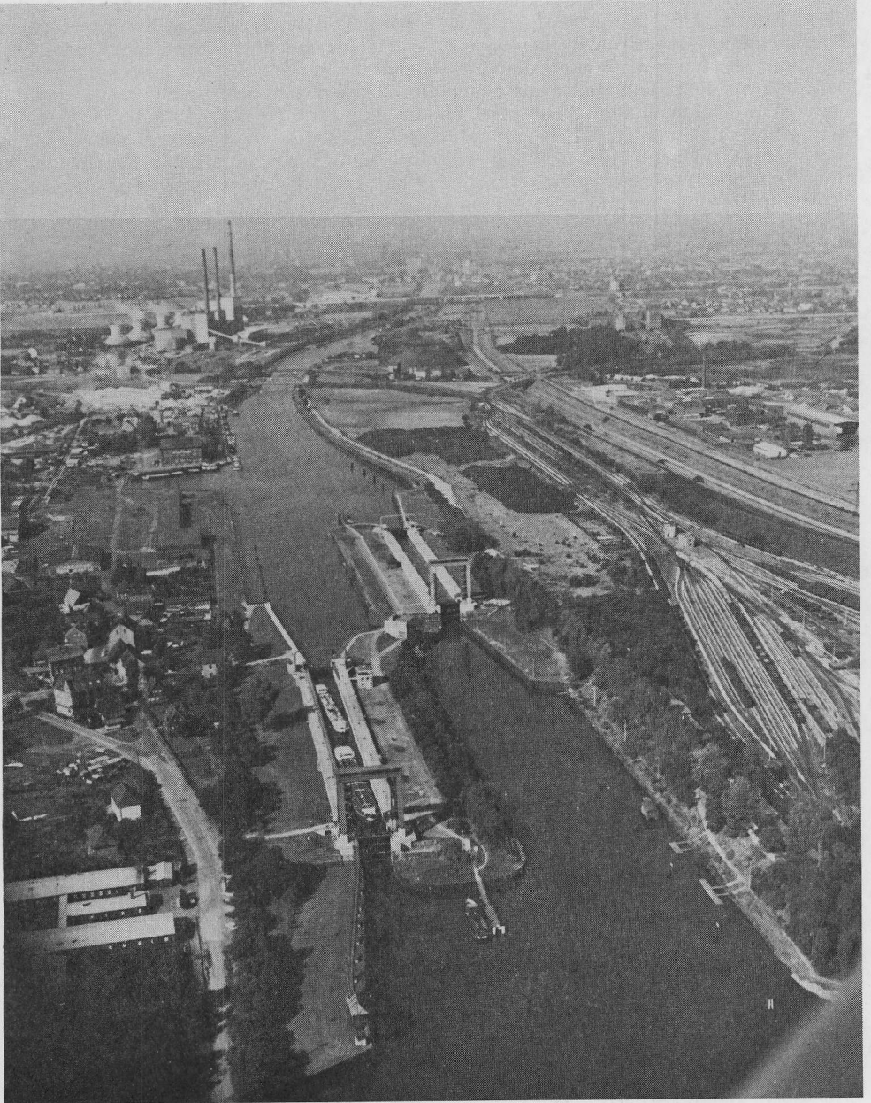
Foto 1: Anordnung der beiden Schleusenammern einer Staustufe
